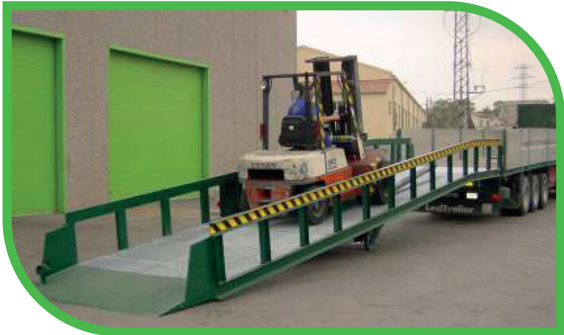
Rampa diseñada cumpliendo normativa UNE-EN 1398
